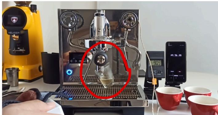
y que ya no alcanzó a atravesar la pastilla. Por eso, al terminar la extracción, la máquina succiona esta agua hacia la ducha y la expulsa por el despitcher.
